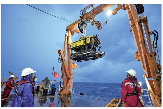
我国自主研制的6000米级深海无人遥控潜水器“海琴”号在南海成功海试
